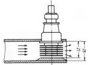
Bild 6. Scheibentriode 2 C 39 A, Anordnung für Luftkühlung
