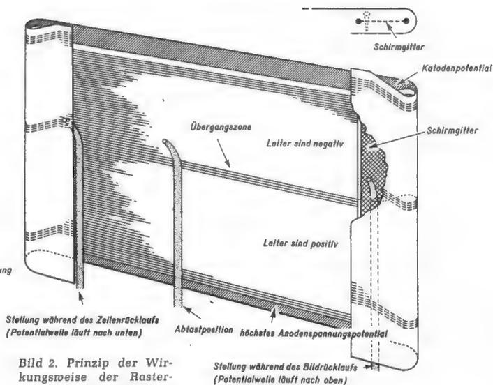
Bild 2. Prinzip der Wirkungsweise der Rasterablenkungs-Anordnung
