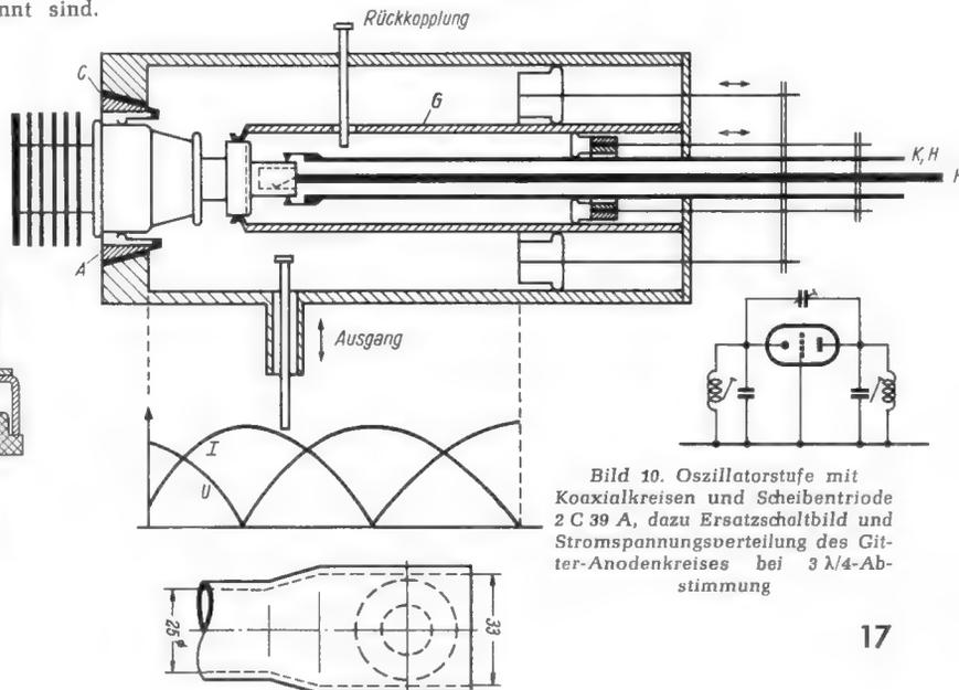
Bild 10. Oszillatorstufe mit Koaxialkreisen und Scheibentriode 2 C 39 A, dazu Ersatzschaltbild und Stromspannungsverteilung des Gitter-Anodenkreises bei 3/4-Abstimmung
