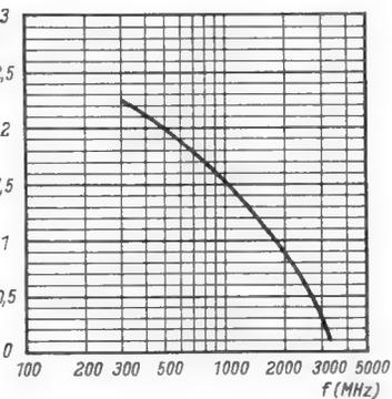
Bild 8. Scheibentriode 2 C 40, Hochfrequenzleistung  $N_{Hf} = f(f)$
