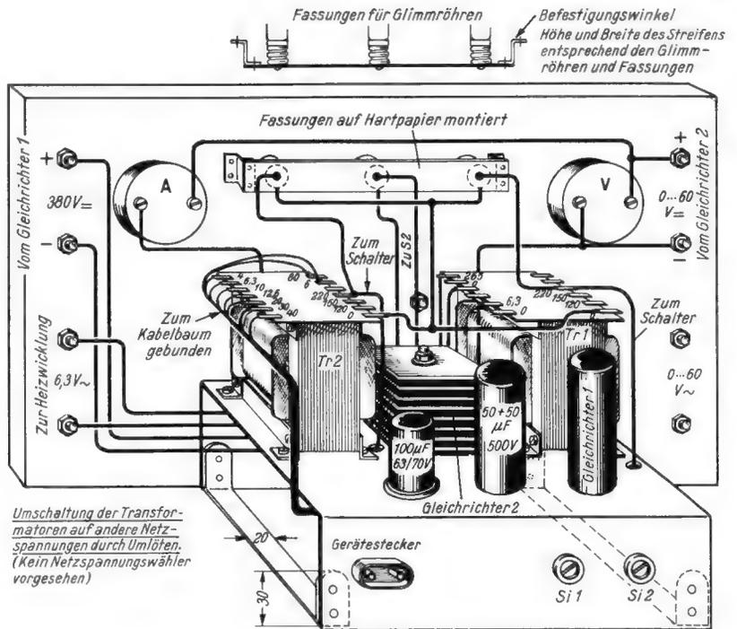
Bild 5. Die Verdrahtung des Chassis von oben gesehen
