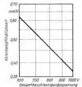
Bild 10. Empfindlichkeit der DG 7-52 A in Abhängigkeit von der Anodenspannung
