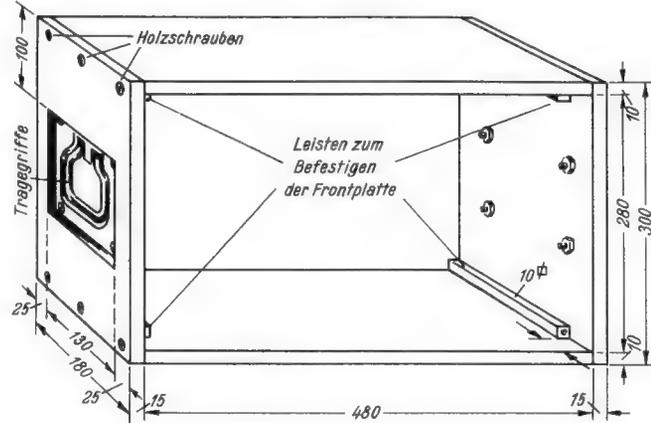
Rechts: Bild 3. Bauangaben für das Holzgehäuse
