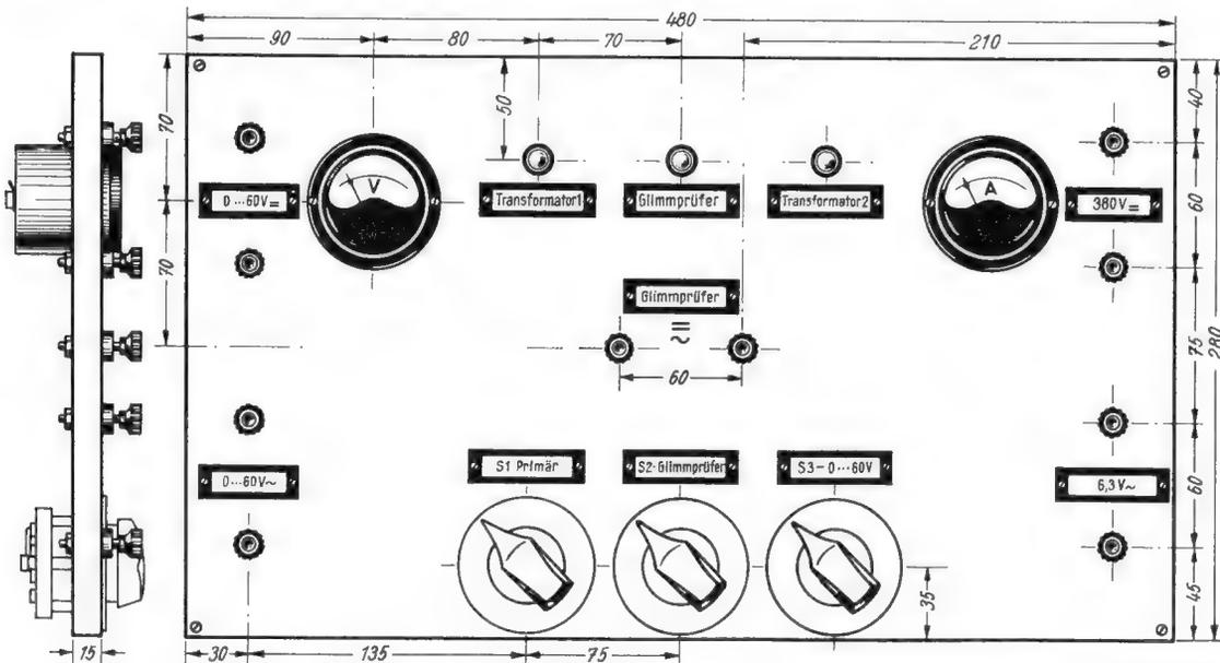
Bild 4. Anordnung der Einzelteile auf der Frontplatte
