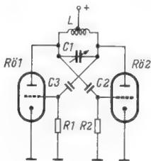
Bild 1. Gegentakt-Oszillator (Balance-Oszillator)
