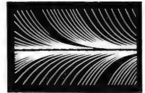
Bild 14. Beispiel der zweckmäßigen Einstellung des Kippgerätes zur Messung der Spitzenwertes der Signalamplitude. Die Kippspannung ist mit der Signalspannung nicht synchronisiert
