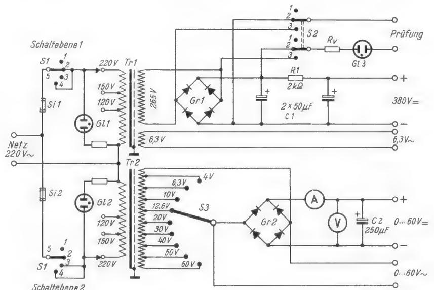
Bild 1. Schaltung des Netzanschlußgerätes. Stellungen des Schalters S 1:
