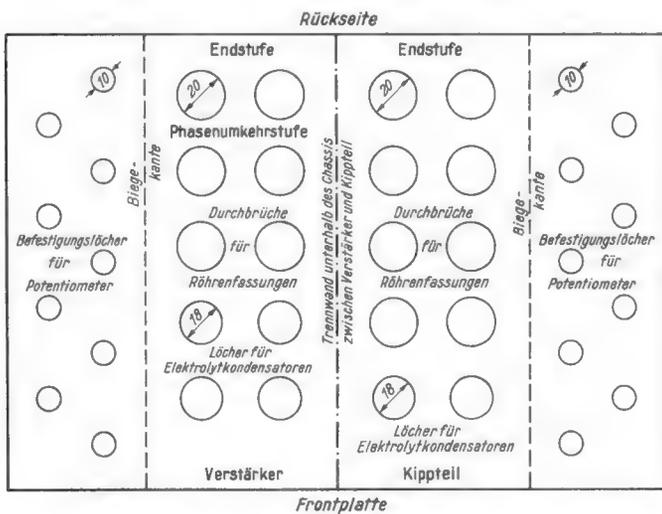
Bild 1. Chassis für Verstärker und Kipprät für Experimentier-Oszillografen, vorgelocht für Röhrenfassungen, Potentiometer und Durchführungen
