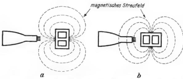
Bild 12. Anordnung des Transformators hinter der Elektronenstrahlröhre. a = richtig, das Streufeld dringt nicht in die Röhre ein, der Leuchtfleck ist scharf; b = falsch, das Streufeld durchsetzt die Röhre, der Leuchtfleck ist unscharf und wird vergrößert
