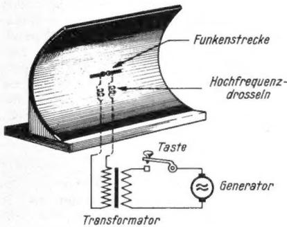
Bild 1. Ludenia-Funkensender für  $\lambda = 25$  cm (1928); in der Brennpolfläche des Parabolspiegels befindet sich der lineare Hertz'sche Oszillator
