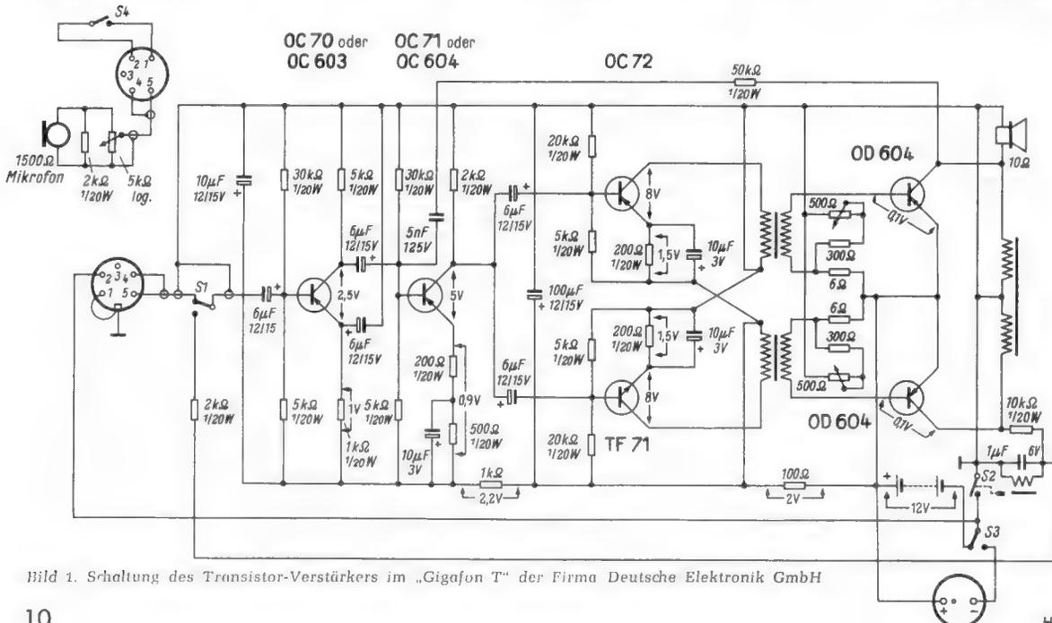
Bild 1. Schaltung des Transistor-Verstärkers im „Gigafon T“ der Firma Deutsche Elektronik GmbH
