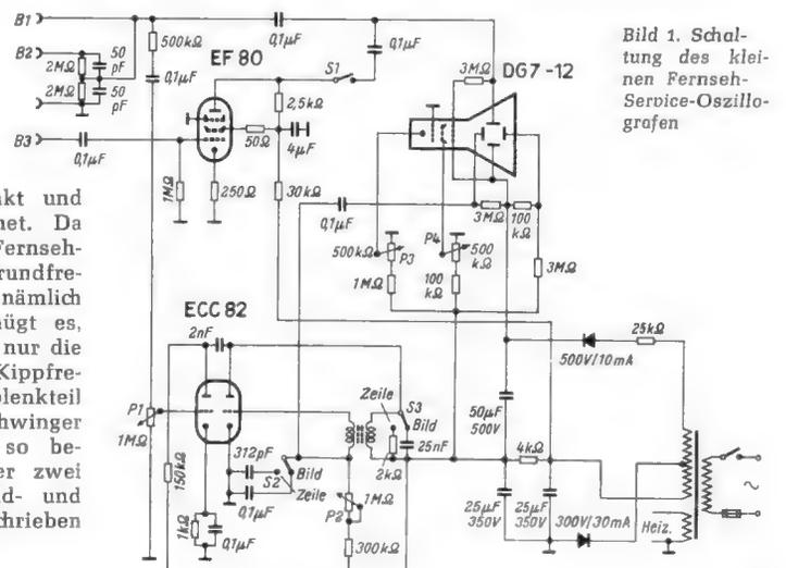
Bild 1. Schaltung des kleinsten Fernseh-Service-Oszillografen
