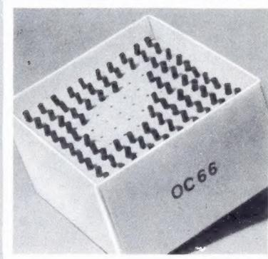
Die kleinen äußeren Abmessungen von Transistoren sind ein wesentlicher Grund dafür, daß diese neuen Schaltelemente in der Gerätefertigung zuerst für Schwerhörigen-Geräte eingesetzt wurden. Inzwischen sind auch die übrigen Bauteile für diese Geräte verkleinert worden, so daß es wünschenswert erschien, die schon an sich winzigen Transistoren in noch kleineren Ausführungen zu fertigen.
