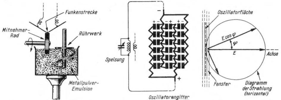
Bild 2. Massenstrahler nach A. Glagoleva-Arkadjewa (1924) für Millimeterwellen, erzeugt durch Funkenüberschlag in Metallpulver
