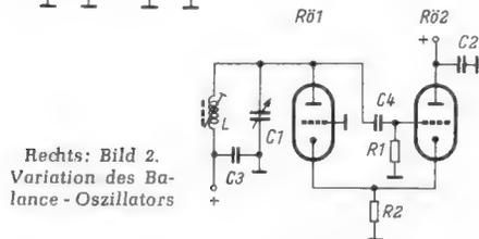
Rechts: Bild 2. Variation des Balance-Oszillators
