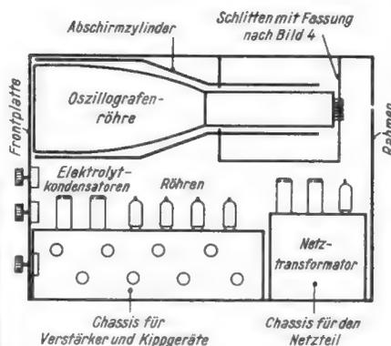
Bild 3. Beispiel der Gesamtanordnung der Chassis in Bausteinform
