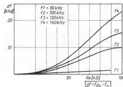
Bild 4. Frequenzänderung des Oszillators in Abhängigkeit von Ra
